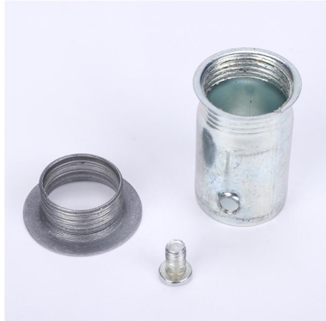
JDG 管(套接紧定式镀锌钢导管、电气安装用钢性金属平导管)是一种电气线路新型保护用导管，连接套管及其金属附件采用螺钉紧定连接技术组成的电线管路，其连接靠管件顶丝顶紧管道，达到紧密连接。无需做跨接地，焊接和套丝，是明敷暗敷绝缘电线保护管路的选择。套接紧定式镀锌钢导管(JDG 导管)是取代PVC 管和SC 管等各类传统电线导管的换代产品，是建筑电器领域采用材料、新技术的一项突破性革新。JDG 管采用镀锌钢管和薄壁钢管的跨接接地线不应采用熔焊连接以及金属导管施工复杂、施工成本和材料成本高等特点，并同时针对PVC 管易老化和防火性能差及接地麻烦等缺点进行设计制造的，是电线电缆的保护神，尤其适用于智能建筑综合布线系统。
